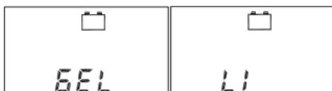
La configuración estándar es "Li". La configuración del tipo de batería repercute en la tensión de corte del regulador. Si se usa una batería Jel o AGM, tiene que cambiar el tipo de batería a JEL.
