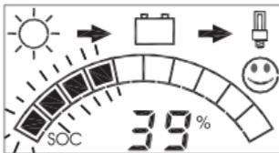
**4.2.8. Preaviso de desconexión contra descarga profunda:**
