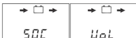
calculado con el fin de usar la batería de forma óptima. Durante la regulación por tensión (UoL) se emplean sólo umbrales de tensión fijos y la barra SOC desaparece del display.
