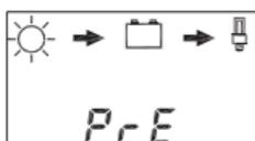
Cuando se llama la configuración predeterminada (PRE) se borran todas las configuraciones que se hayan hecho hasta ese momento y el regulador es reseteado a la configuración de fábrica.
