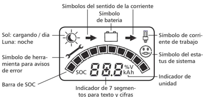
Pulsando la tecla izquierda se puede cambiar entre los diferentes indicadores de pantalla. El indicador seleccionado se mantiene de no cambiarlo. Para volver nuevamente al principio se deberá seguir pulsando la tecla izquierda hasta que aparezca el indicador de SOC.
